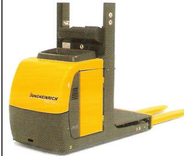
Dikey Sipariş Hazırlayıcı Model EKS 110 Maks. Kapasite: 1000 kg. Maks. Uzanma Yüksekliği: 4600 mm.
