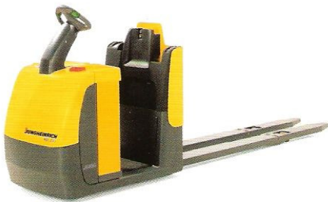
Yatay Sipariş Hazırlayıcı Model ECE 220 Maks. Kapasite: 2000 kg. Maks. Uzanma Yüksekliği: 2. kat
