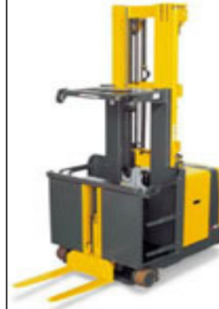
Dikey Sipariş Hazırlayıcı Model EKS 110 Maks. Kapasite: 1000 kg. Maks. Uzanma Yüksekliği: 4600 mm.
